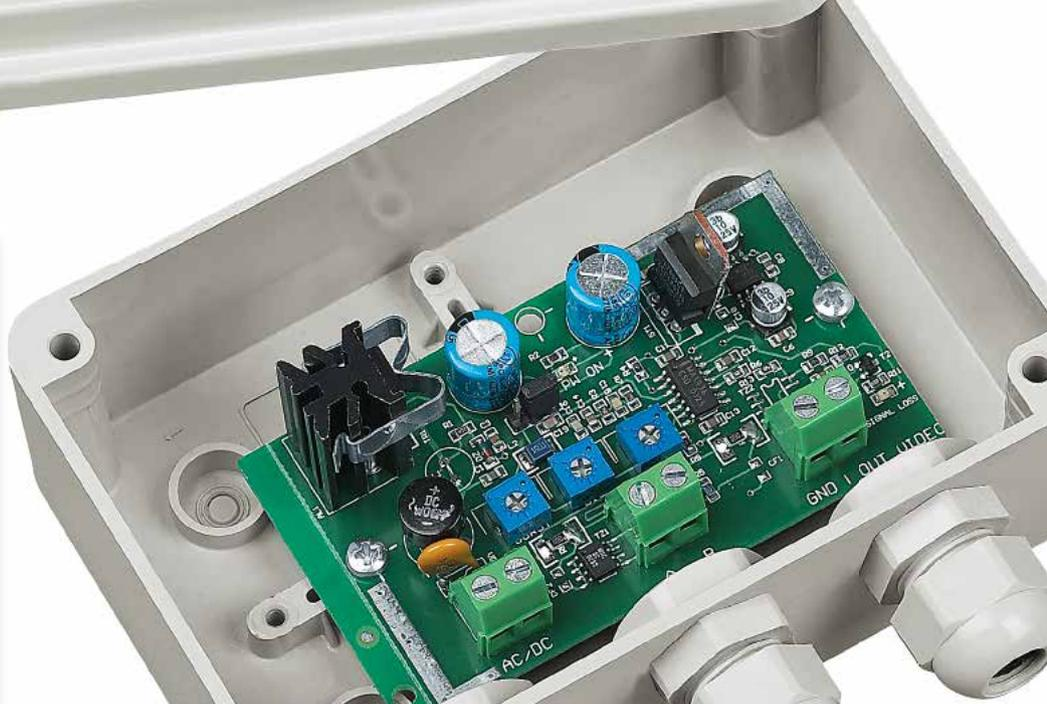
Die Videotec Videoübertragungssysteme umfassen Sender/Empfänger mit Doppelader zur Übermittlung von Signalen über große Entfernungen.
