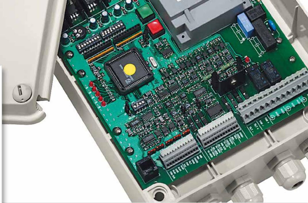
Für die Fernsteuerung der Schwenk-Neige-Köpfe im Außenbereich wurde eine Serie von Telemetrieempfängern - von einfachen bis zu komplexen Modellen - entworfen, mit denen die Funktionen der S-N-Köpfe und der motorisierten Optiken geregelt werden können.
