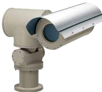
Die robusten explosionsgeschützten Schwenk-Neige-Köpfe der Baureihe EXPT eignen sich für die Verwendung in explosionsgefährdeten Bereichen und besitzen die Zertifizierung „Ex d“ für die Zone 1 und 2, Gruppe IIC für Gas sowie die Zertifizierung „Ex tb“ Zone 21 und 22 für Stäube. Sie sind beständig gegen aggressive atmosphärische Einflüsse, Bruchbelastungen, Reinigungsmittel, Salznebel und extrem niedrige Temperaturen.
